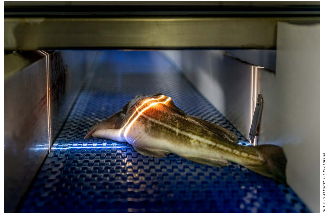
Ved bruk av hyperspektralt kamera, kan kvaliteten på rund fisk måles uten at det er behov for å skjære i den.
